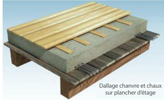
Dallage chanvre et chaux sur plancher d'étage
